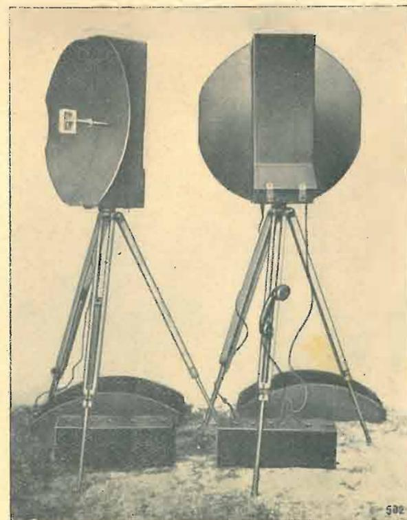
Fig. 1. - Due completi ricetrasmittitori montati su trepiedi.
